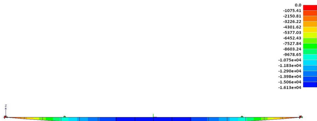
Figura 19 - Copertura: diagramma di momento flettente M3-3 per carichi totali allo SLU
